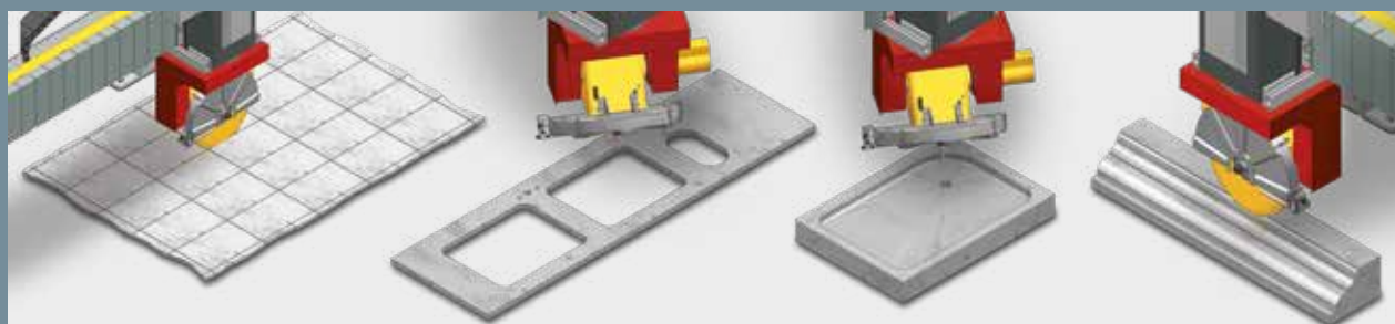
Linear and crossed cuts | Simple and complex shaping | Kitchen tops complete with holes and inclined cuts | Shower plates Tagli lineari e incrociati | Sagomatura semplice e complessa | Piani cucina completi di forature e tagli inclinati | Piatti doccia
